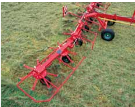
Do przetrząsania granicznego zewnętrzne karuzele są wychylane hydraulicznie.
