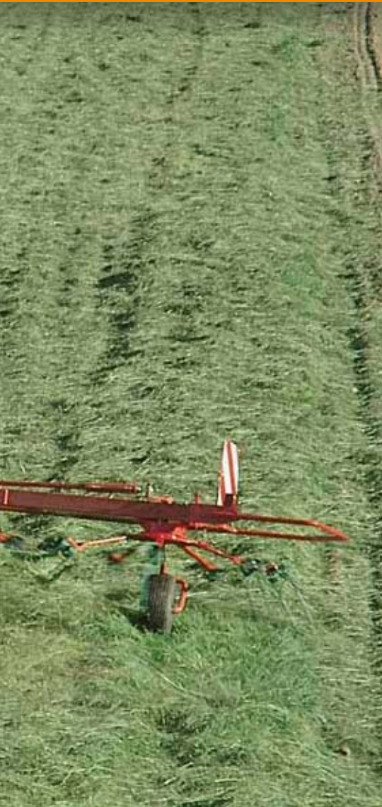
Przetrzęsacz Kverneland 85111 T można podczepić zarówno do dolnego dyszla w ciągniku jak również do belki łączącej dolne ramiona.
