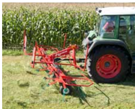
Regulacja do pracy wzdłuż krawędzi pola pozostawia całą masę wewnątrz pola.
