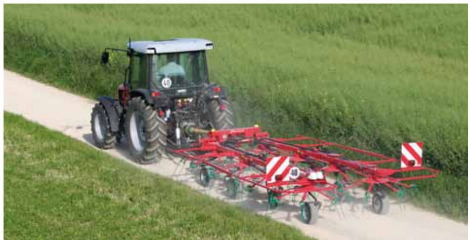
Podczas transportu przetrzęsacz porusza się w obrysie oraz śladach ciągnika.
