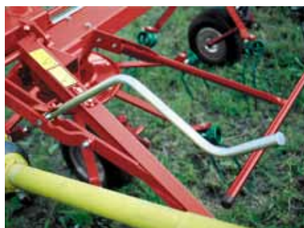
Wysokość pracy palców przetrzęsacza Kverneland 8583 T jest regulowana mechanicznie za pomocą korby umieszczonej przy zaczepie.
