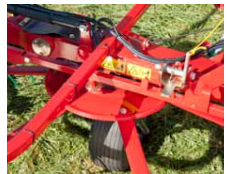
Centralna regulacja do pracy wzdłuż krawędzi pola - standard w każdym modelu.
